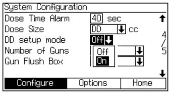
Fig. 27. Configure Screen 4, dynamic dosing setup mode enabled
